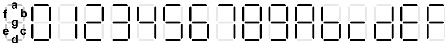
Abbildung 2: Darstellung von Hexadezimalzahlen auf einer Sieben-Segment-Anzeige.
