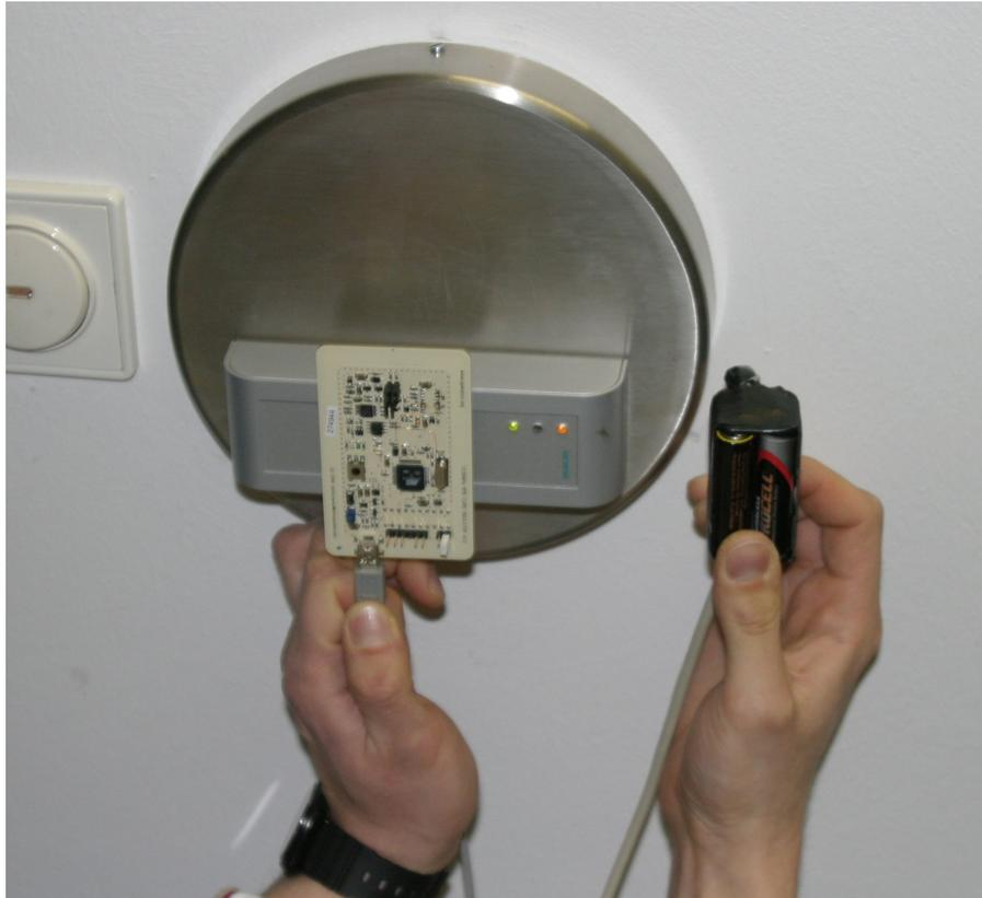
Abbildung 4.2: OpenPICC mit Batterien beim Öffnen einer Tür mit einer zuvor einprogrammierten UID
